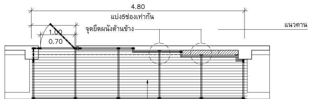
กรอบตาข่ายเหล็ก LG.11/2"x11/2" หนา 1.8 มม ทาสีใกล้เคียงกับสีผนังอาคาร หลังคา METAL SHEET สี ALUZINC. หนาไม่น้อยกว่า 0.30 มม.
